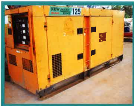
220KVA GENERATOR SET
